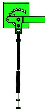
15. Coloque el control de flujo de alimento en la barra transversal, con el lado posterior sobre el costado de la barra. Instale el mecanismo utilizando el perno de 5/16 x 7/8 pulg. y la tuerca de 5/16 pulg.
